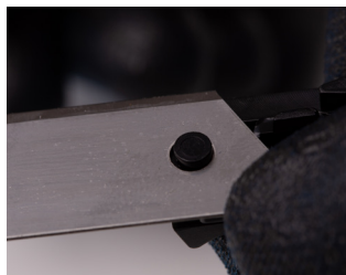
włóż z powrotem ostrze pamiętając o dokładnym włożeniu ostrza w wystającą wypustkę
